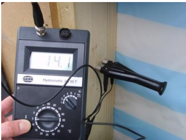
Bild 4: Widerstands-/Leitfähigkeitsmessgerät. Hier: Untersuchung der Holzfeuchte
