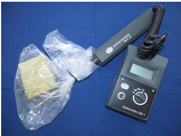
Bild 7: Hygrometrische Feuchtemessung eines Baustoffes in einer „Prüfkammer“.
