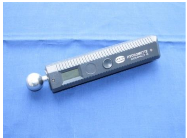
Bild 5: Kapazitives Feuchtemessgerät (Kugelsonde)
